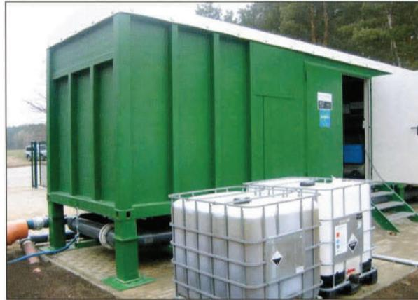
Abb. 17: Pelicananlage mit einer Leistung von  $70 \text{ m}^3$  pro Stunde mit nachgeschaltetem Absetzteich
